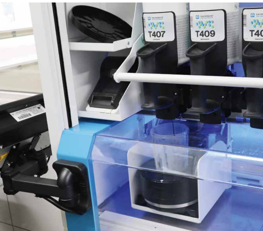
PÅ VEKTA: Systemet veier opp riktig mengde blandingsfarge på vekten.
