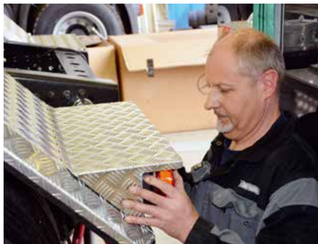
Trond Haugen jobber nå med montering av påbygg på lastebiler. Her er det en baklykt som skal på plass.
