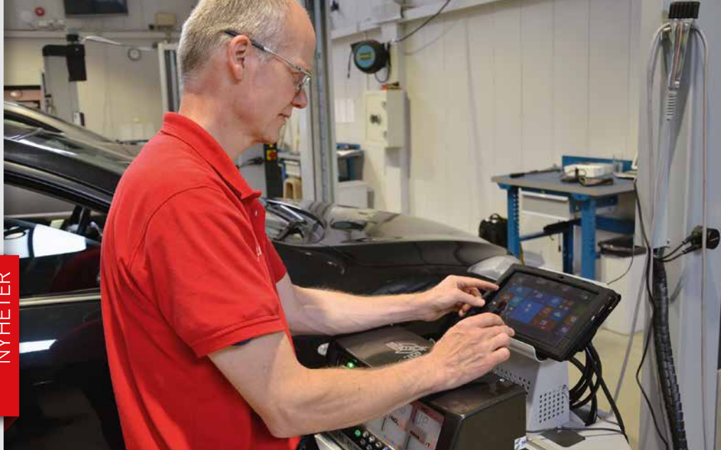
Teknisk leder Gunnar Teig i Viking Kontroll i full sving med en avgasstester på en bensinbil.
