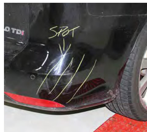
Typisk spot repair-skade.
