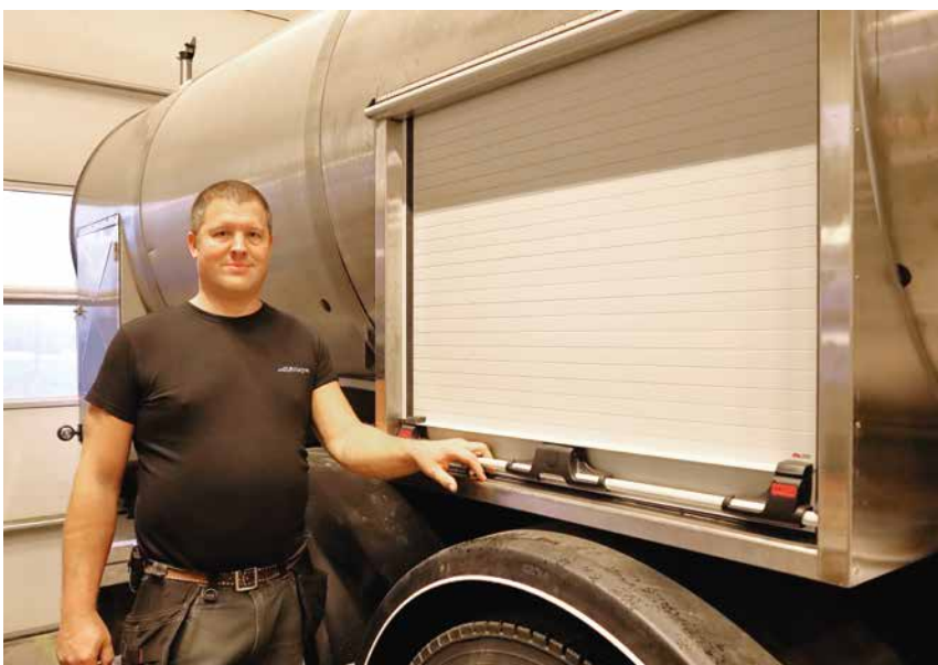
Helge Stolpnes ved en brukt melketank som nå får et nytt liv på en branntankbil. – En tre-roms melketank er noen ganger for stor for en brannbil, så da bygger vi gjerne inn et skap i den midtre tanken, sier han.
