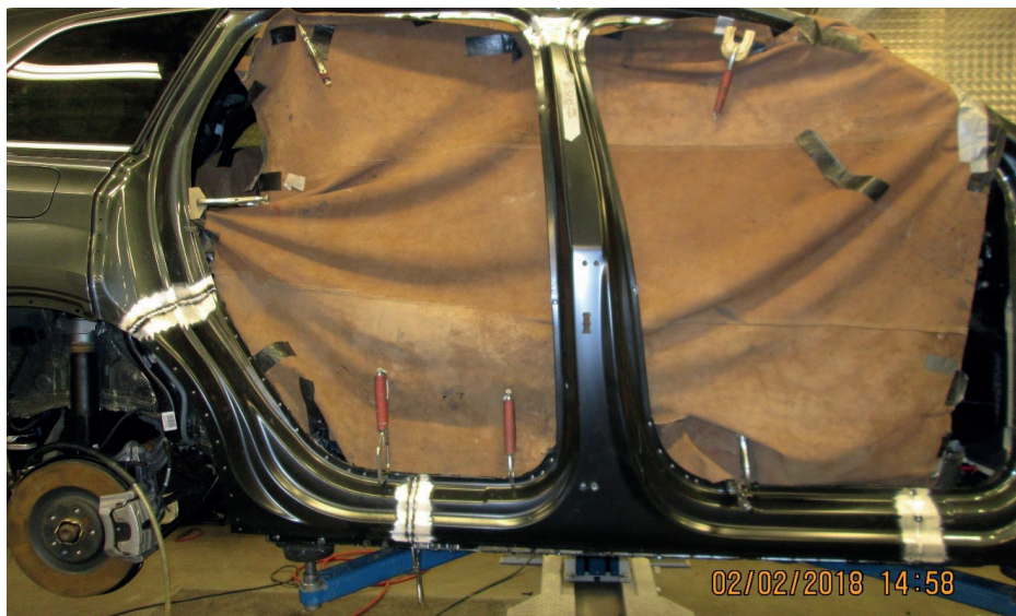
Bilder av reparasjonen, i dette tilfelle sveising av B-stolpe og terskel.
